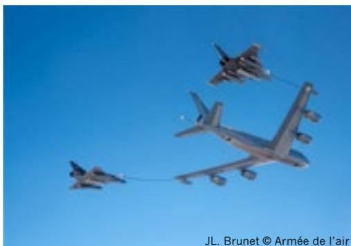
Ravitaillement en vol d'un Rafale et d'un M2000N
